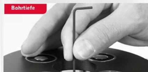
Die Bohrtiefe ist ab Werk voreingestellt. Die Bohrtiefe wird durch die unter dem Bohrer befindliche Inbusschraube in der Bohrachse mit Hilfe des mitgelieferten Montagewerkzeugs justiert.
