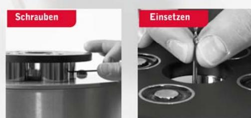
Immer zuerst das Gerät ausschalten und den Netzstecker ziehen. Mit dem beiliegendem Inbusschlüssel die beiden seitlichen Madenschrauben in der Bohrspindel lösen und den Bohrer herausziehen. Den neuen Bohrer einsetzen und beide Madenschrauben gleichmäßig fest anziehen. Um eine neue Bohrtiefe einzustellen, bitte wie im Absatz „Bohrtiefe einstellen“ verfahren. Das Gerät wieder einschalten und Probebohrungen durchführen.
